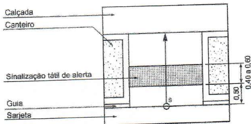
Figura 2: Rebaixamento de calçada com faixa de serviço/canteiro.
